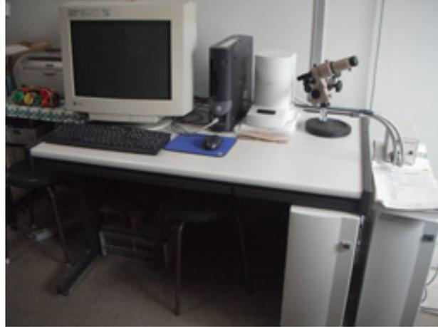
図 2: 装置写真。机の上には、右から、光学顕微鏡、AFM（島津製作所製 SPM-9500）、専用のデータ処理装置 (PC) がある。机の右下には、AFM の制御ユニットがある。
